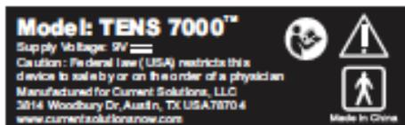
La etiqueta adherida a la parte posterior del dispositivo contiene información importante acerca de este modelo de dispositivo, el voltaje de alimentación y las precauciones. Por favor, no la retire.
