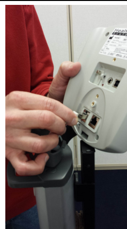
Prise du câble de la cellule de charge
