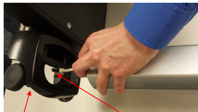
Connecteur du câble de la cellule de charge
