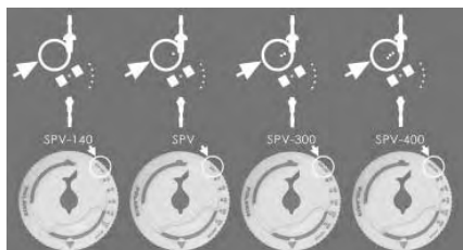
Figure 15 : Identification radiographique des différents modèles et corrélation avec la gamme de pression sur le Sélecteur.
